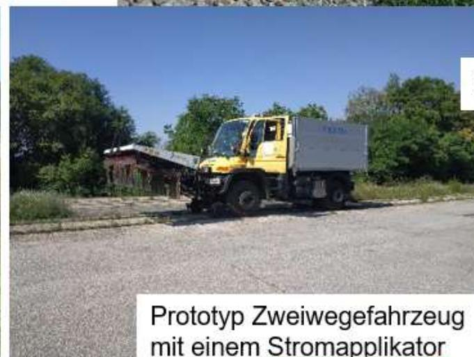
Prototyp Zweiwegefahrzeug mit einem Stromapplikator
