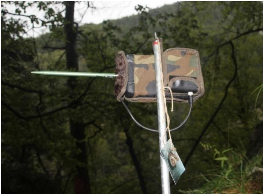
Abbildung 1: Batcorder (Foto: O. Gebhardt)
