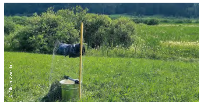
Lichtfalle am Projektstandort im Hörfeldmoor: akkubetriebene Schwarzlichtröhre auf Fanggefäß
